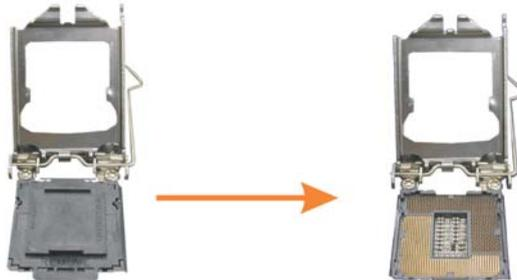
**步骤 3:** 找到插槽上的三角缺口，CPU 上的金点应指向此缺口，CPU 必须按正确的方向放入。
